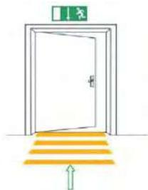
Les portes des voies d'évacuation seront ouvertes dans le sens de la fuite, rapidement et en tout temps, sans recours à des moyens auxiliaires. Les portes verrouillables dans les voies d'évacuation seront munies de systèmes de fermeture conformes aux normes SN EN 179.
